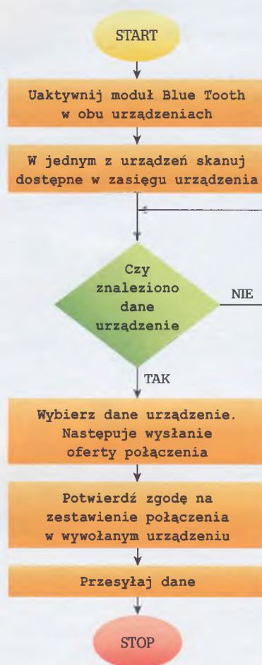
Rys. 28.2. Proces zestawienia połączenia P2P urządzeń z Bluetooth
