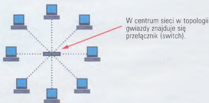
Rys. 28.4. Sieciowa topologia gwiazdy
