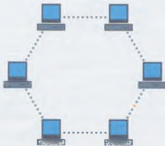
Rys. 28.7. Przykład sieci o topologii pierścienia
