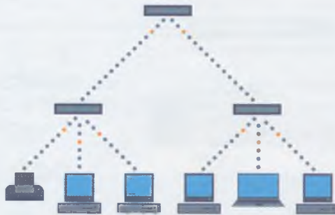
Rys. 28.6. Przykład sieci o topologii gwiazdy rozszerzonej
